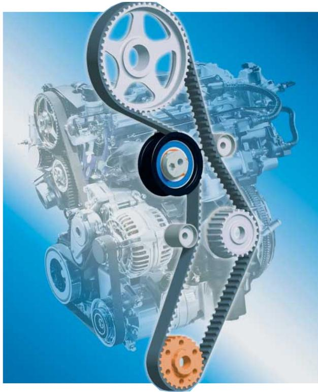
**Der Bauraum macht's:** Trotz der unbestreitbaren Verbesserungen in der Zahnriementechnik entscheiden sich die Autohersteller derzeit vermehrt für einen Antrieb der Nockenwelle mittels Steuerkette.
